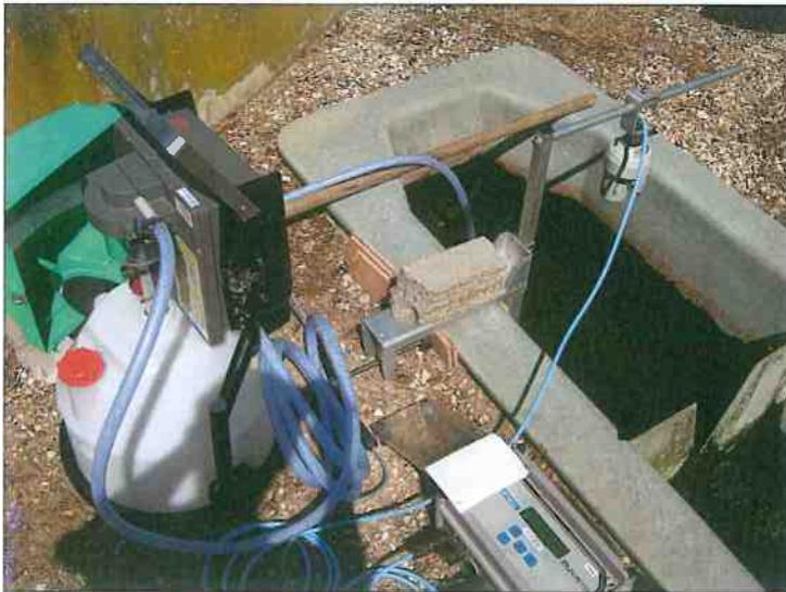
A la sortie, le matériel de prélèvement utilisé était de marque HYDREKA, modèle AquaCell. Il mettait en œuvre le principe de prélèvement des eaux par pompe à dépression.
